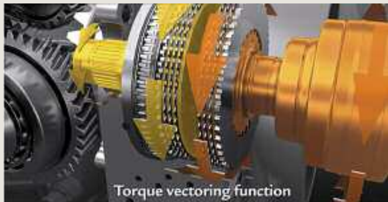
Le due frizioni di compensazione che lavorando in modo differenziato permettono di realizzare il "torque vectoring", ovvero l'applicazione di una coppia motrice non simmetrica alle ruote anteriori
