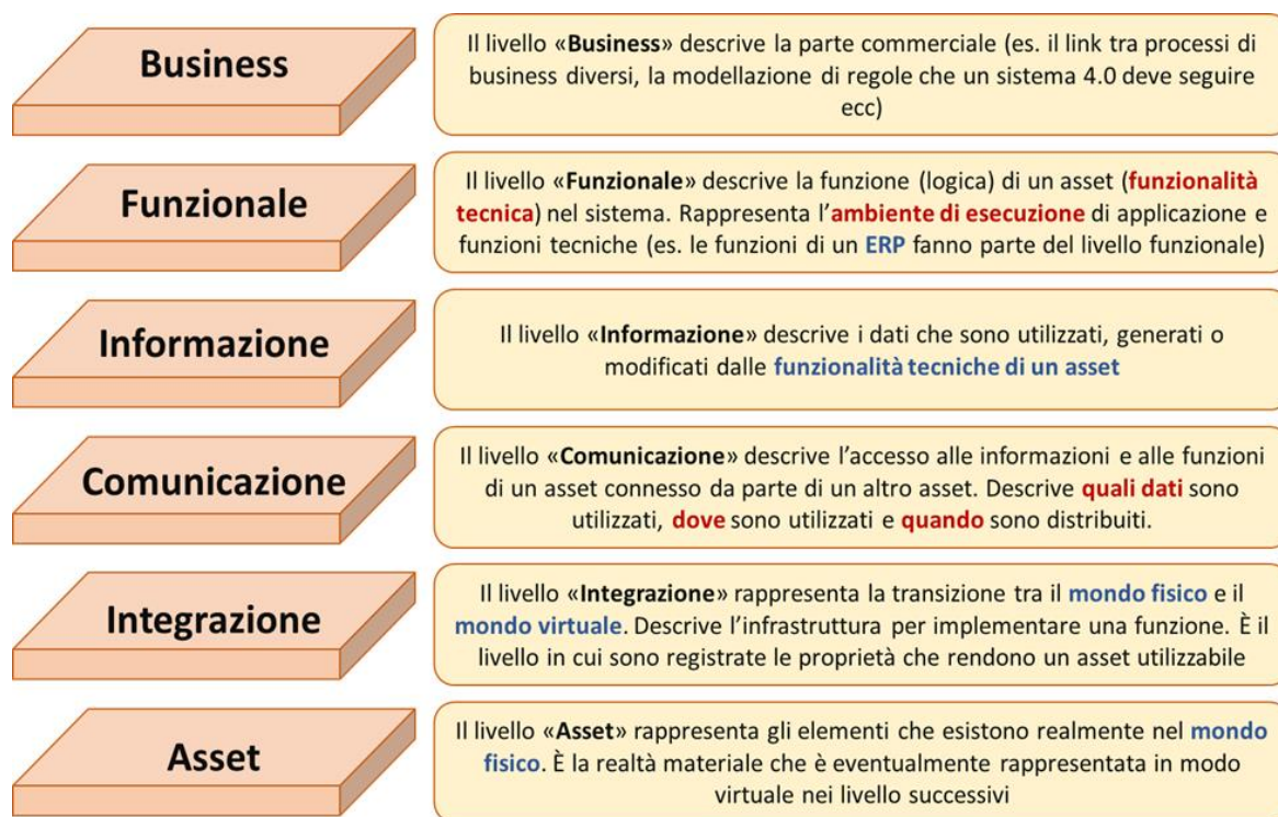
Figura 2 – Layer del RAMI4.0 per tradurre un asset fisico nel suo duale digitale.
